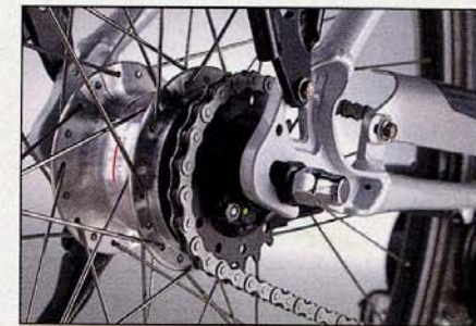
•Tuning: Die 7-Gang-Freilaufnabe bietet mit kleinerem Ritzel mehr Entfaltung.
